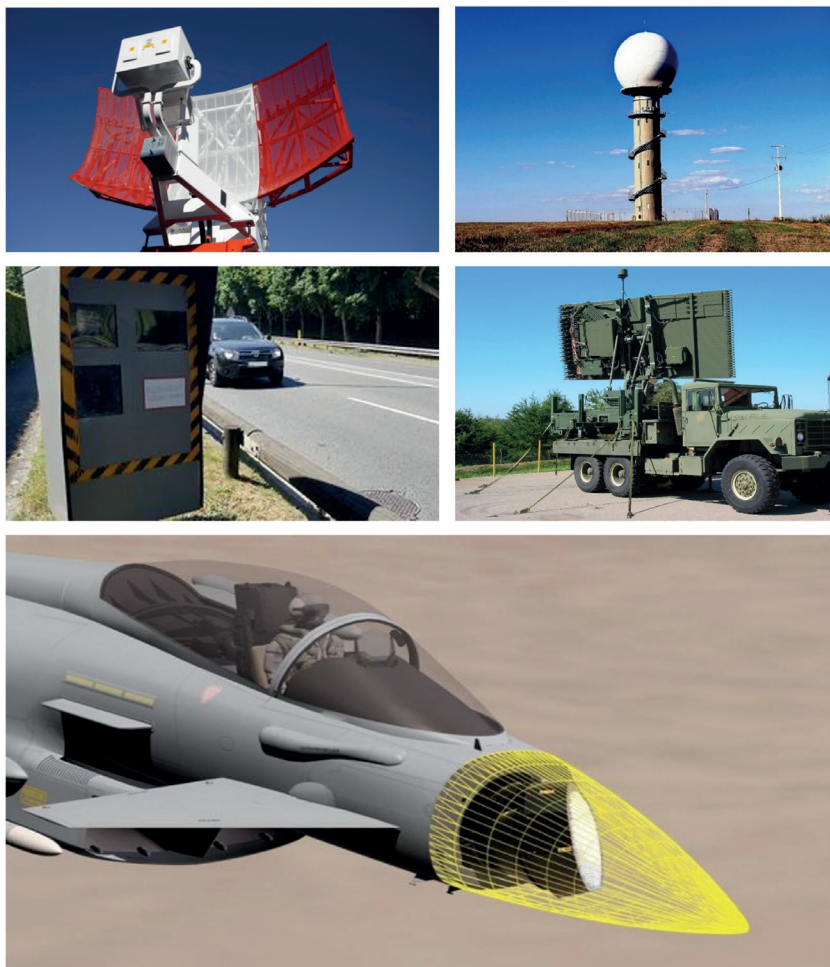
Figura P.3. Imagen compuesta 6 que muestra diversos equipos actuales de radar, en la variedad de usos en los que se emplean: de izquierda a derecha y de arriba abajo: radar de control de tráfico aéreo; radar meteorológico; radar de control de velocidad; radar militar AN/TPS-78 de alerta temprana terrestre; imagen artística de la situación de la antena del radar del avión de combate europeo Eurofighter.
